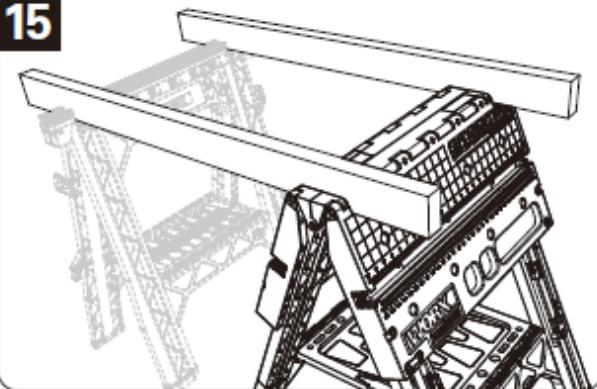
Чтобы использовать Pegasus в качестве козел, полностью раскройте ножки, пока лоток для инструментов не станет горизонтально. Он совместим с зажимными козлами производства нашей компании (не входят в комплект поставки). (Рис. 15)
