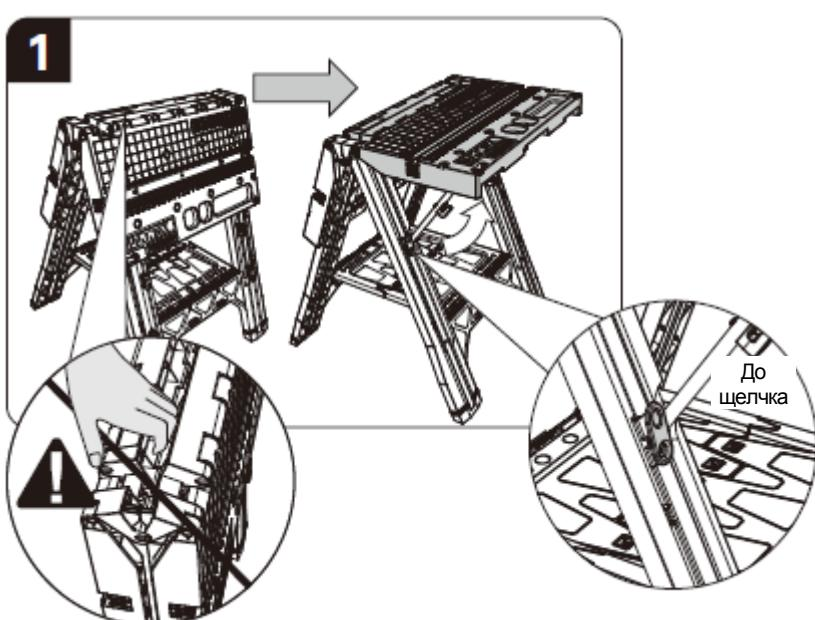
Чтобы использовать Pegasus в качестве верстака, полностью раздвиньте ножки и потяните поверхность стола вверх, пока фиксаторы не защелкнутся. (Рис. 1).
